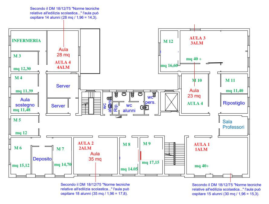
Secondo il DM 16/02/92 "Norme prevenzione incendi per l'edilizia scolastica" punto 5.6 e il D.Lgs 81/2008 "Testo Unico per la Sicurezza del Lavoro" allegato IV punto 1.6.3, essendo le aule dotate di una porta di accesso ad un'anta, con apertura verso l'interno del locale, larghezza <120 cm, possono ospitare massimo 25 persone.
